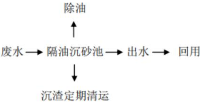
图 5.1-1 施工机械和车辆冲洗废水工艺
